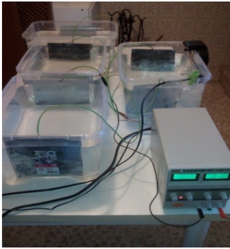
Figura 3. Configurația pentru realizarea Gans-ului de ZnO pentru creier.
